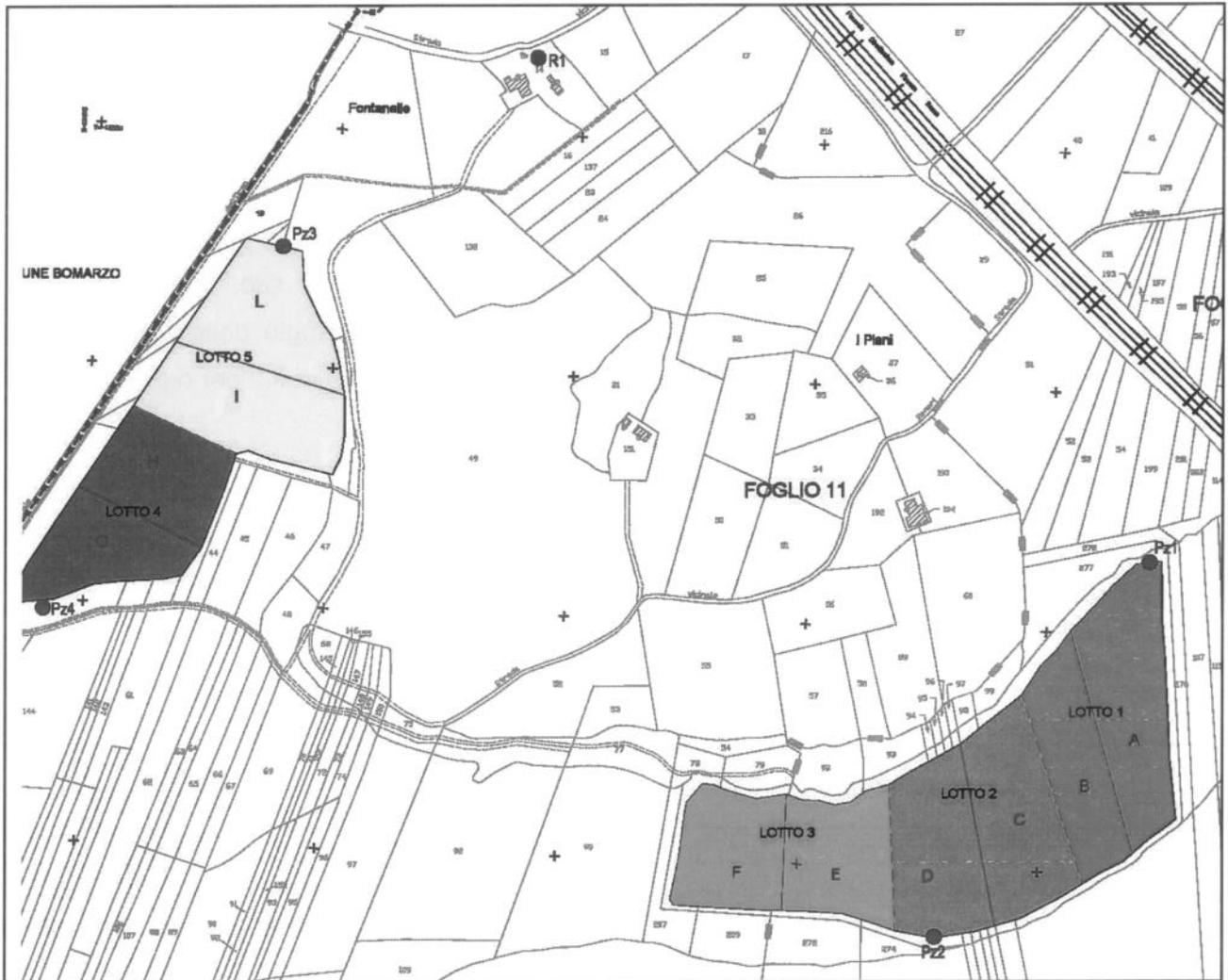
**Fig.1:** ubicazione punti di monitoraggio; il punto R1 è il recettore per il monitoraggio polveri e rumore - i punti Pz1, Pz2, Pz3 e Pz4, sono quelli individuati per il monitoraggio delle acque di falda
